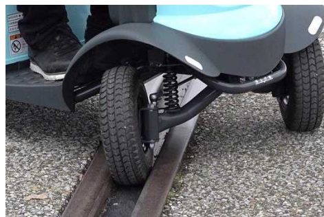
写真5 前輪が線路の溝に挟まっている様子
